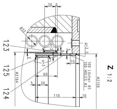
Anordnung der Blechverkleidung an der Wandbohrung
